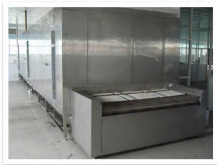
氨机制冷平板速冻隧道
